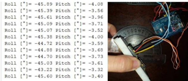
Figura 14. Demonstração dos ângulos ao inclinar o sensor MPU6050 em 45 graus no sentido negativo do vetor de posição x (ângulo de arfagem, roll).
